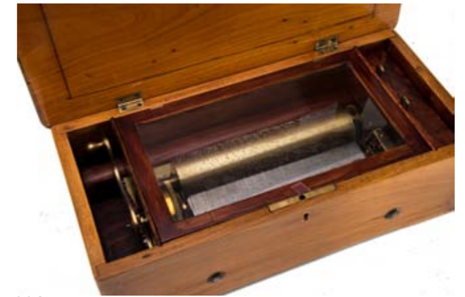
881 Musikspieluhr, Nicole Freres Geneve 19. Jh. Rechteckiges Gehäuse aus Nussbaum, Deckel mit Fächerblatt und Rocaillen in hellem bzw. hellgrün gefärbtem Obstholz intarsiiert, feine Bänderinlage. Zungenspielerwerk über Messingstiftwalze mit Kammabnehmer. 4 Melodien. H.: 15 cm. Br.: 42 cm, T.: 21 cm. Funktionsfähig. (10697) 400 €
